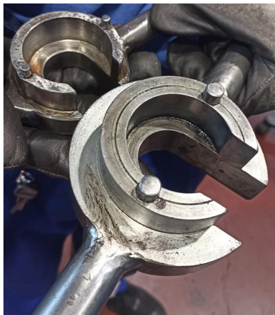
Figura 8. Ejemplo de útil con tetones para roscar/desenroscar tuercas de amortiguadores.
