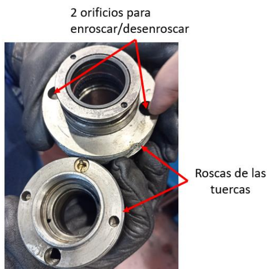
Figura 7. Ejemplo de tuercas embebidas.
